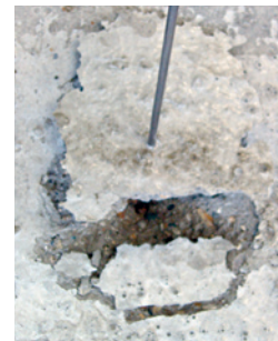
Kein Ausreißen der Sticks No chunking of the stick
