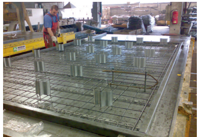
Produktionspalette mit KAP-STAHL-WELLE Production pallet with KAP-STEEL-WAVE
